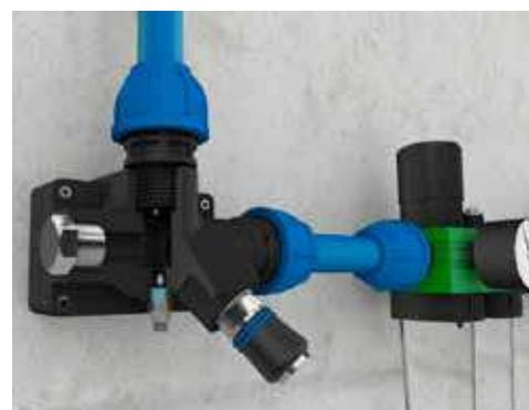
Para el montaje del purgador, efectúe un orificio con un taladro en la parte inferior, teniendo cuidado de no dañar la rosca. Luego rosque el purgador habiendo puesto con anterioridad algún tipo de sellante.
