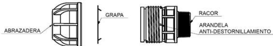
Enrosque la abrazadera hasta que ejerza una presión que le impida roscar fácilmente. Inserte el tubo a través de la abrazadera y ejerza presión hasta que se inserte en la arandela anti-destornillamiento. Para tener la certeza de que esto ocurre, se puede verificar realizando una marca en el tubo partiendo de un extremo hasta la medida "L" según el diámetro del tubo como se muestra en la siguiente tabla.
