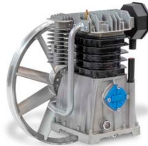
Nuevo Cabezal A49B de 2 etapas que mejora la eficiencia llevándola a niveles muy superiores. Aportando hasta 444 lts/min de caudal con tan solo 3 HP de potencia. Y además a muy bajas revoluciones, con baja sonoridad y llegando a alcanzar 11 bares de presión.
