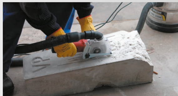
MINI AMOLADORA CORTANDO CON CÁRTER DE ASPIRACIÓN
