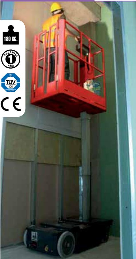
Plataforma aérea de elevación y tracción eléctrica. Se puede conducir desde el cesto con la plataforma totalmente elevada a 2,21 m. Dimensiones compactas que le permiten pasar por puertas y pasillos con la plataforma bajada (760 x 1100 x h1500 mm). Equipada con un joystick para una conducción sencilla.
