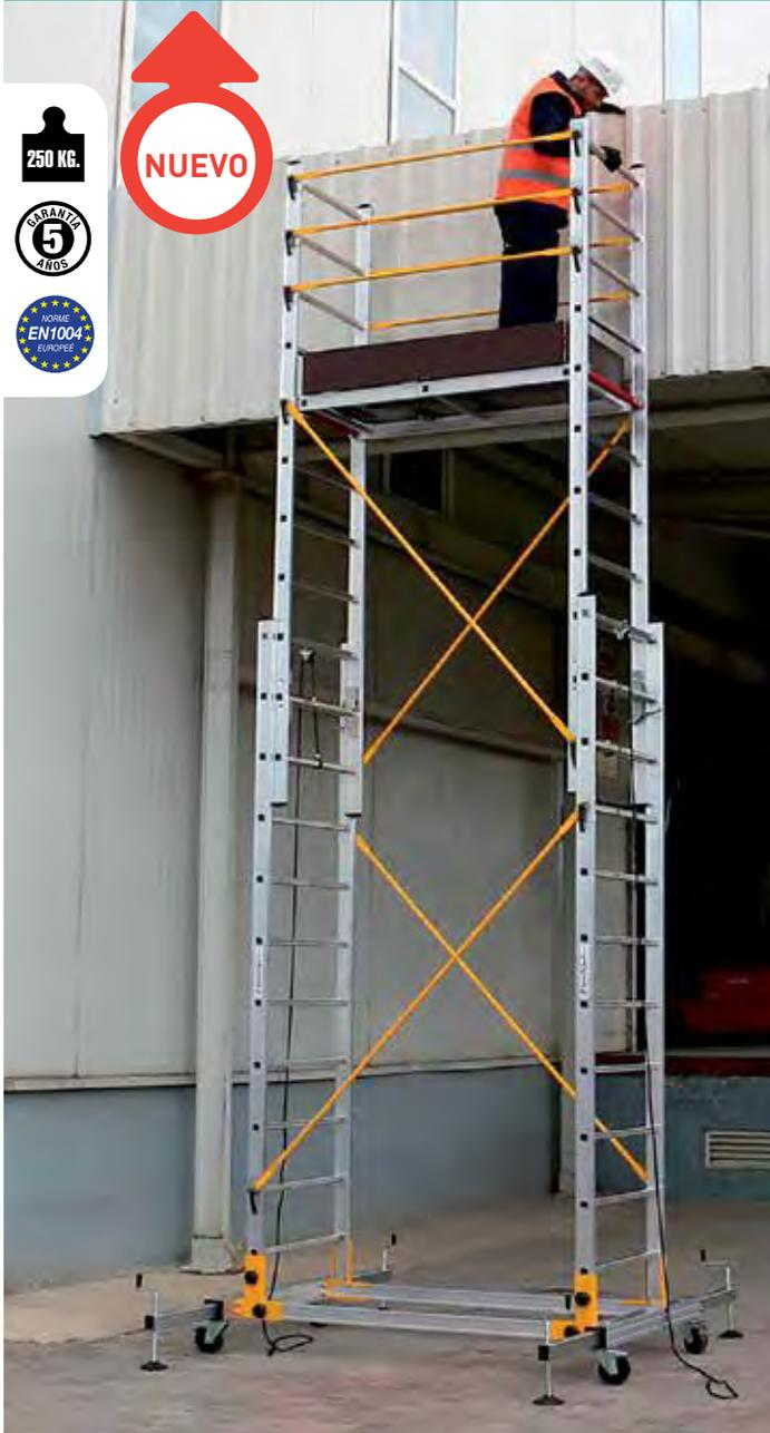
Andamio de aluminio telescópico transformable con travesaños de acero pintado. Los laterales del andamio son dos escaleras extensibles que elevan la plataforma peldaño a peldaño para alcanzar la altura deseada.
