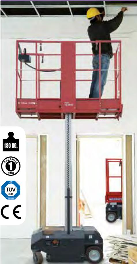
Plataforma aérea de elevación y tracción eléctrica. Se puede conducir desde el cesto con la plataforma totalmente elevada a 2,90 m. Plataforma de trabajo extensible a ambos lados de 1115 a 1700 mm. de longitud. Con la plataforma bajada pasa a través de pasillos y puertas (739 x 1150 x h1727 mm)
