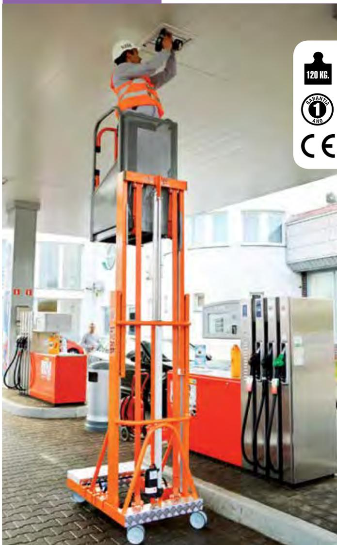
Plataforma aérea telescópica, equipada con elevación eléctrica y empuje manual. Las ruedas se bloquean al elevarse la plataforma. Dispone de un asa para poder empujarla. Muy ligera, fabricada en aluminio. Para su transporte se pueden desmontar sus contrapesos (4 piezas de 15 kg.) y la batería (9 kg.)
