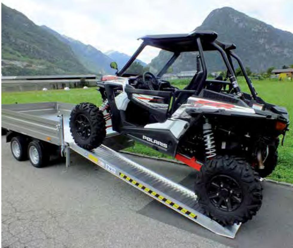
En Svelt fabricamos rampas para carga de cualquier vehículo: automóviles, motos, vehículos agrícolas, maquinaria pesada, plataformas aéreas, vehículos de rueda de oruga metálica, etc... Producción robusta en aluminio conforme a la normativa europea UNI EN 1389.
