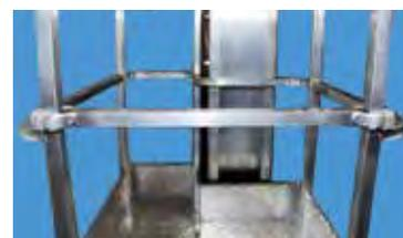
Entrada a plataforma con barra de seguridad móvil
