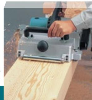
Equipo básico: Llave allen de 4 mm, desviador de viruta, minicuchillas HSS, escuadra de ajuste y boquilla de aspiración.
