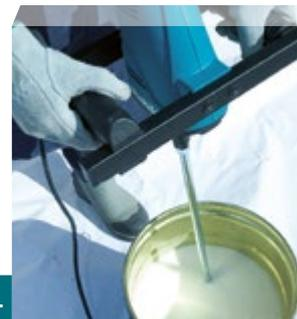
Para agitar y mezclar pinturas, cola, adhesivos... hasta 30 Kg de masa.
