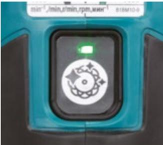
El modo de acabado facilita el pulido fino al mantener el par fijo y controlar la rotación en trabajos pesados.
