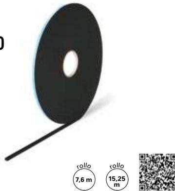
Cinta de espuma de poliuretano semirrígida resistente al rasgado y equipada con un adhesivo acrílico de doble cara de alto rendimiento para pegar metal y vidrio. Esta cinta está protegida por una lámina de polietileno que se retira fácilmente sin romperla Espaciador y componente no estructural, permite que el aire y la humedad lleguen al sellador de silicona para un agarre óptimo.
