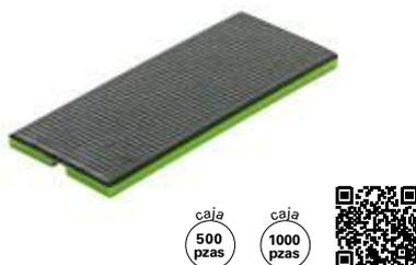
Las cuñas de acristalamiento universal, consisten en una base de plástico rígido, recubierta con una superficie lisa y estriada para absorber los movimientos y golpes del vidrio aislante y así evitar daños. Estas cuñas se pueden aplicar en superficies planas y proporcionan el drenaje gracias a su canal inferior.
