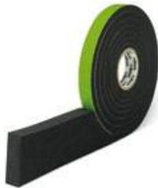
El sistema de sellado TP615 está basado en una espuma de poliuretano con células abiertas, impregnadas en el interior en base a una mezcla estable de resina sintética (libre de ceras y bitumen), que proporciona las siguientes características principales:
