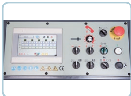
Cuadro mandos Control panel
